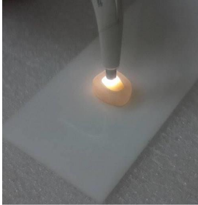
شكل رقم (19) يبين طريقة قياس اللون باستخدام القاعدة الأكريلية
