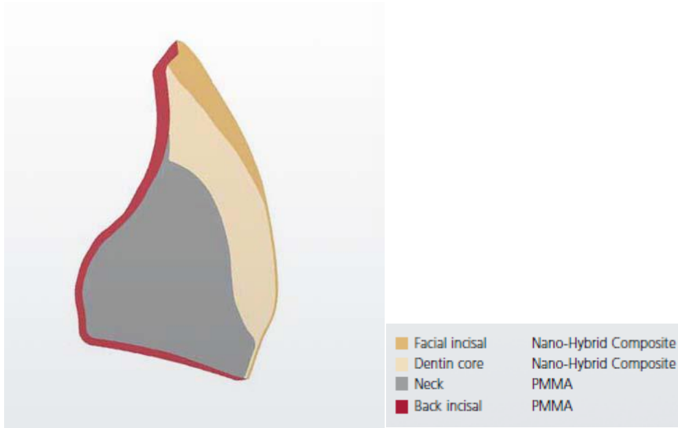
شكل رقم (7) توزيع المواد التي تتألّف منها أسنان
