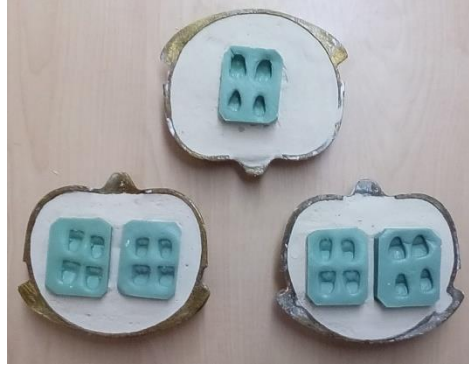
شكل رقم (15) يبين إنزال القوالب المطاطية ضمن بواتق
